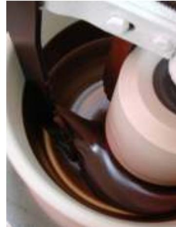
El material obtenido después de la molienda, se coloca en un mortero de porcelana o en su defecto, en una licuadora, se procede a molerlo o licuarlo hasta obtener un licor de textura fina y suave ( $<20\mu$ ).
