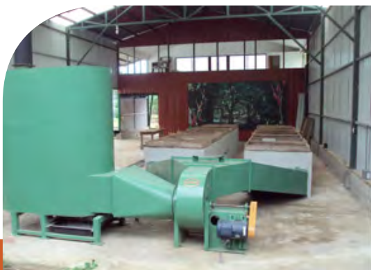
Secador mecánico moderno de leña en Finca La Amistad. 2012.
