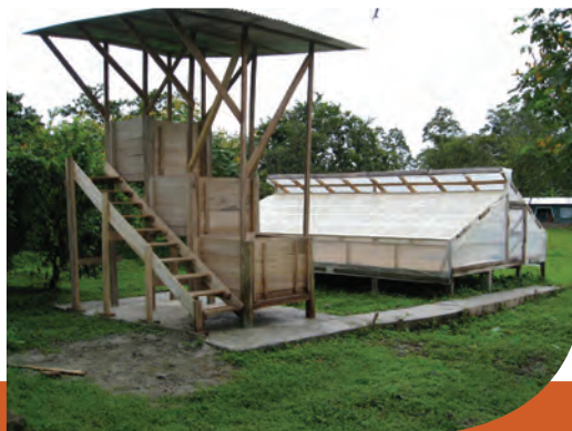
Un modelo de secadoras tipo marquesinas construídas de madera y plástico.
