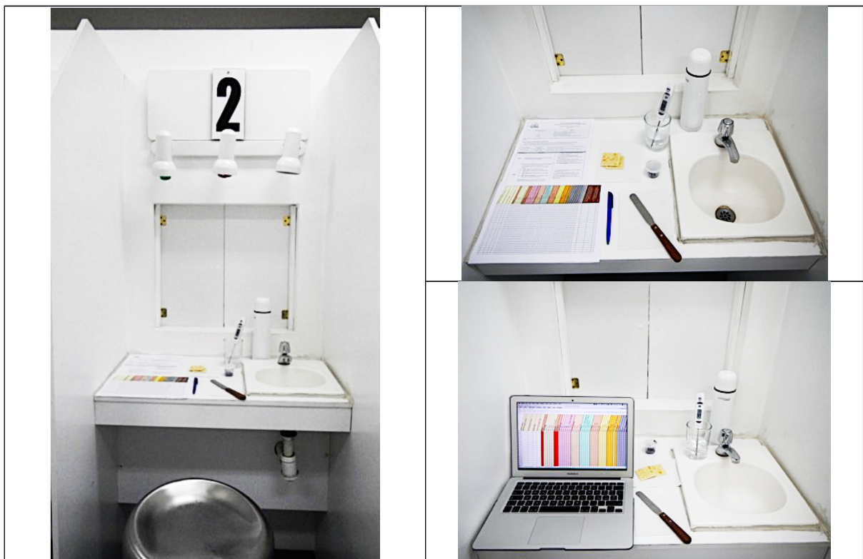
Figura 11. Cubículo equipado con equipo para registrar calificaciones (papel y bolígrafo o marcador inodoro, o computador), termómetro para el agua, espátula y termo con agua para la evaluación sensorial del licor de cacao (Crédito: D. Alvarado/ Alianza entre Bioversity International y el CIAT)
