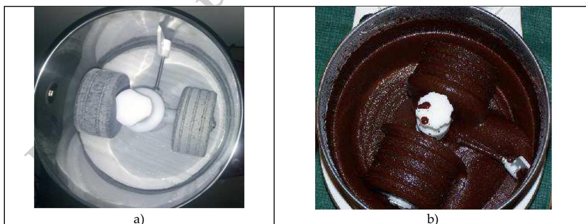
Figura 4. Interior del melanger: a) vista de las piedras de moler dentro del recipiente de piedra vacío; b) vista del recipiente durante el refinamiento de los nibs en licor de cacao.
