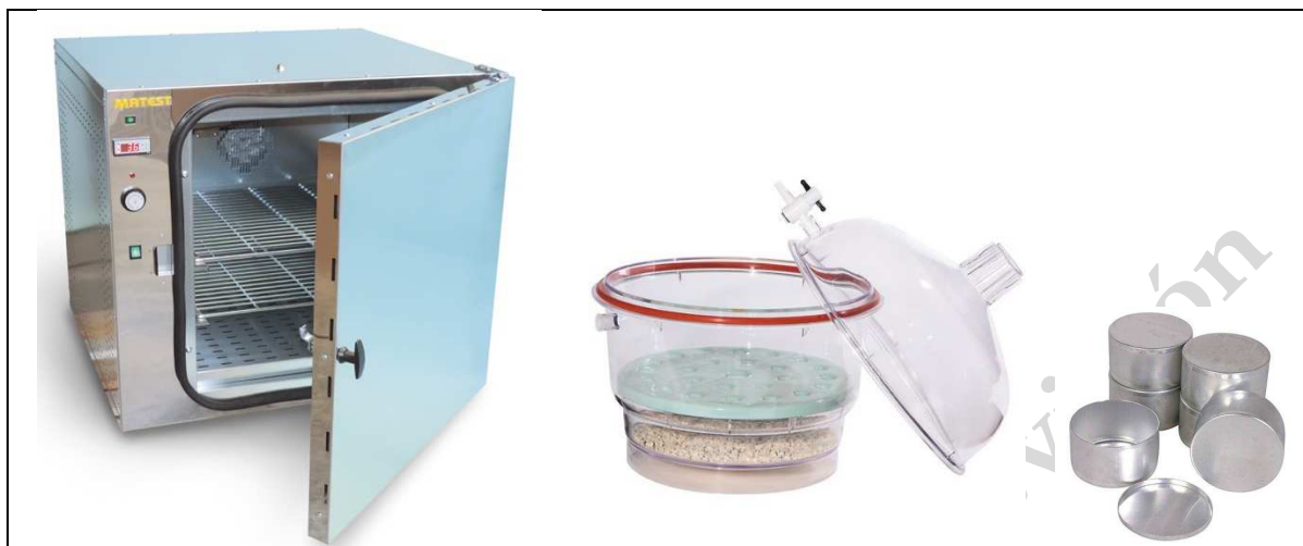
Figura 2. Horno (izquierda), desecador (medio) y recipientes metálicos (derecha) para medir contenido de humedad usando el método de secado al horno. (Crédito: http://www.matest.com/en/product/a005-04-kit-forced-ventilation-oven , https://www.coleparmer.co.uk/i/complete-vacuum-desiccator-plate-y-desiccant-kit-250-mm-diameter/2500033 , https://www.thomasci.com/scientific-supplies/Aluminum-Dishes-With-Cover )
