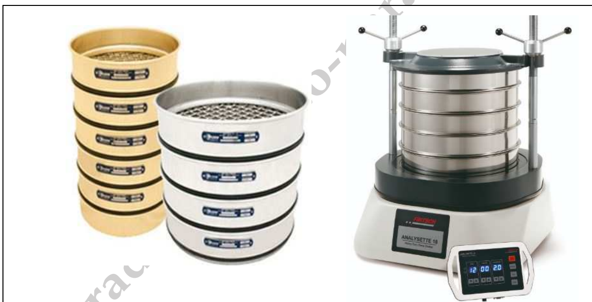
Figura 2. Izquierda: Tamices para evaluaciones que cumplen con los estándares ISO usados para separar las partículas de polvo de los granos de cacao. Derecha: Agitador mecánico de tamices para análisis y medición del tamaño de las partículas (Crédito: https://www.globalgilson.com/iso-test-sieves ; https://lavallab.com/products/sieve-shaker-sifter-test-sieve/heavy-duty-sieve-shaker/ )
