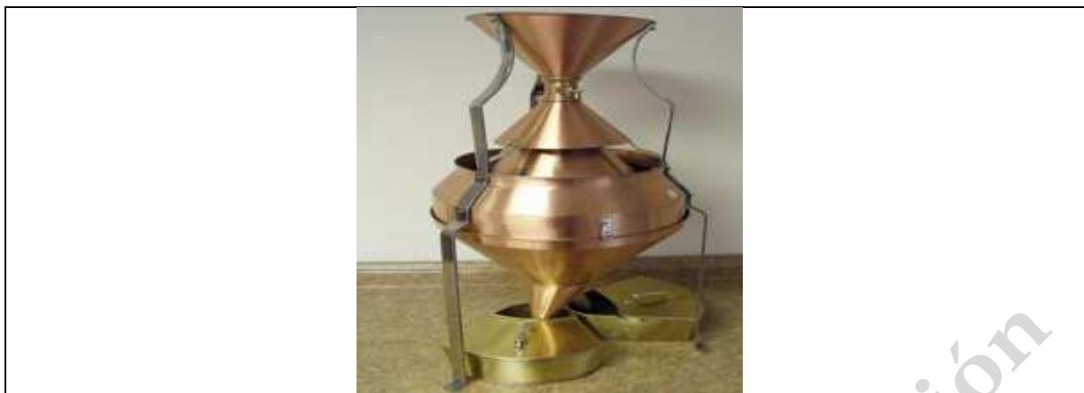
Figura 8. Divisor cónico para muestras de granos de cacao (Crédito: http://www.coffeelabequipment.com/BOERNER.html – en inglés)
